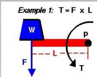
Si el tornillo se encuentra ubicado en el punto P, y queda ajustado correctamente cuando se aplica una fuerza W de 5 Kg a una distancia L de un centímetro, el Torque (fuerza angular de ajuste) aplicado será de 5 Kg-cm.
